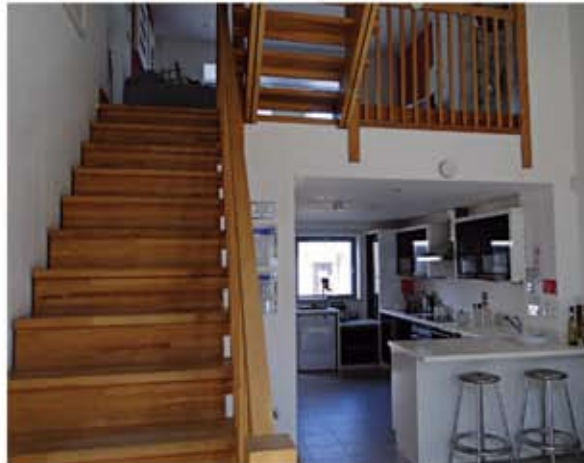
İç hacim, merdiven, doğal havalandırma sirkülasyonu olarak işlev görüyor
