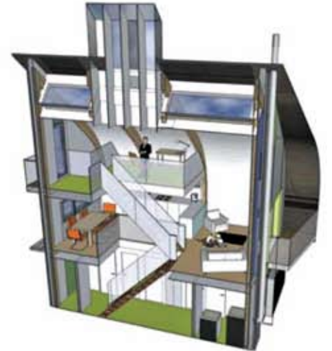
Kesit şeması, ısınan havanın yükselerek üst katlarda dolaşması prensibi kullanılmış
